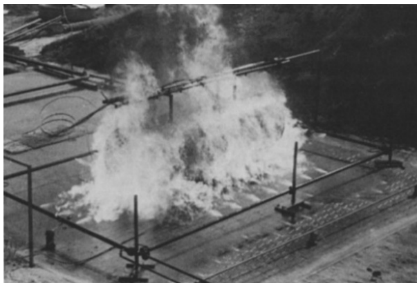
Рисунок 5. Фрагмент огневых испытаний емкости с СУГ
